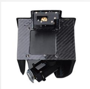
抛投云台 Air Release Unit
